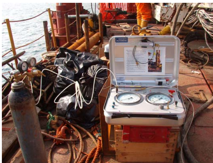
Esecuzione prova dilatometrica con dilatometro Marchetti
