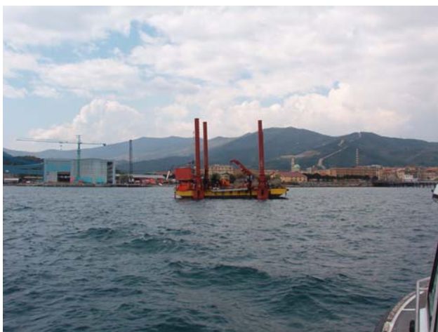
Piattaforma autosollevente sulla quale si sono svolte le indagini al largo del porto di Vado Ligure.
