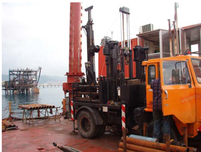
Esecuzione prove penetrometriche con cono sismico SCDTU
