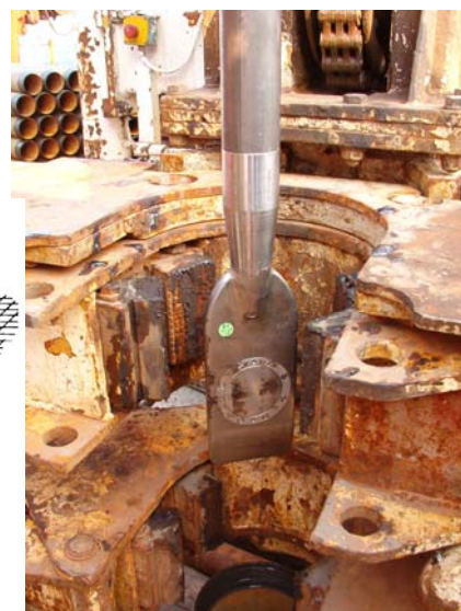
Schema di esecuzione prove dilatometriche. Dettaglio dilatometro Marchetti
